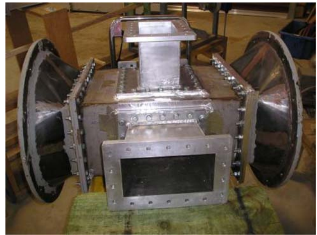
Fig. 3 MW applicator for railway sleepers with power supply to the applicator via four ports (radiators). (a) Diagram, central part of the sleeper cross section is heartwood (MC = 25–40%), the rest—sapwood (MC = 70–120%), (b) applicator photo Abb. 3 Mikrowellenvorrichtung für Eisenbahnschwellen mit Energiebeaufschlagung über vier Kanäle (Radiatoren). (a) Schema, der innere Bereich des Schwellenquerschnitts ist Kernholz ( u = 25\text{--}40\% ), der Rest ist Splintholz ( u = 70\text{--}120\% ), (b) Foto der Vorrichtung
